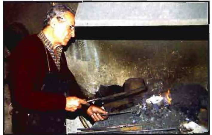
Diego calienta el plomo que necesita para rellenar los pilones.
