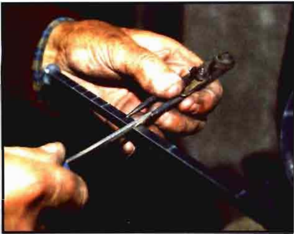
Con un compás marca las muescas para colgar el contrapeso.
